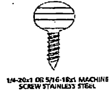
(38) THUMB SCREW SCALE: FULL SIZE
